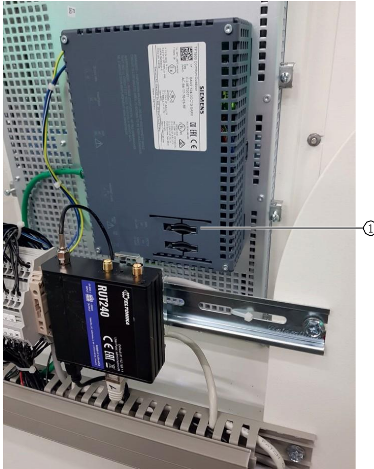
Bild 8-21 Position des Einschubschachtes der Kunden-SD-Karte
