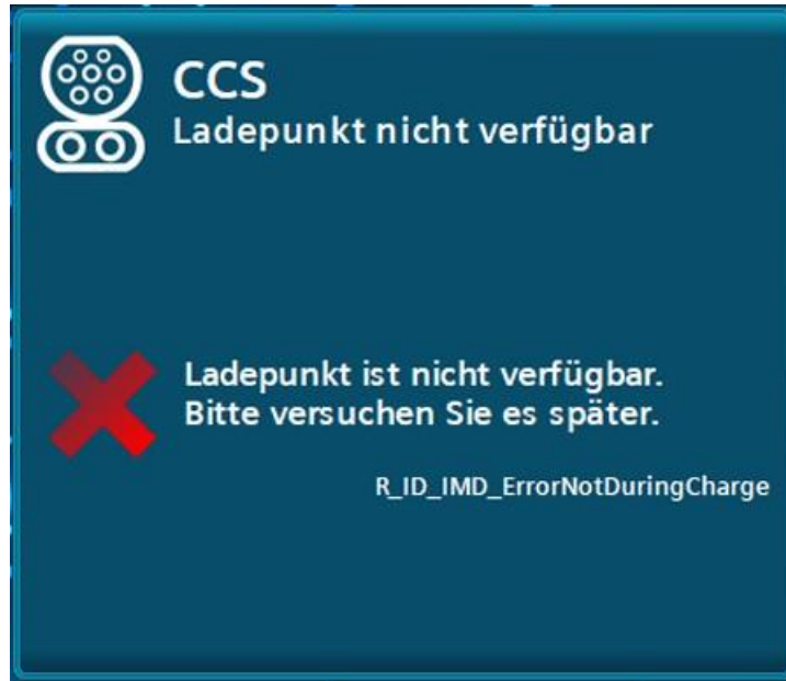
Bild 8-17 Ladepunkt nicht verfügbar mit Fehlercode
