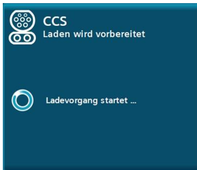
Bild 8-10 Beispiel für die Wartezeit beim Starten des DC-Ladevorgangs
