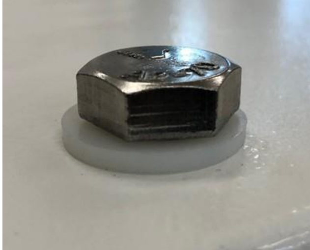
Bild 5-8 Ersatz der Augenschrauben (Kranösen) durch Verschluss-Schrauben und Dichtung
