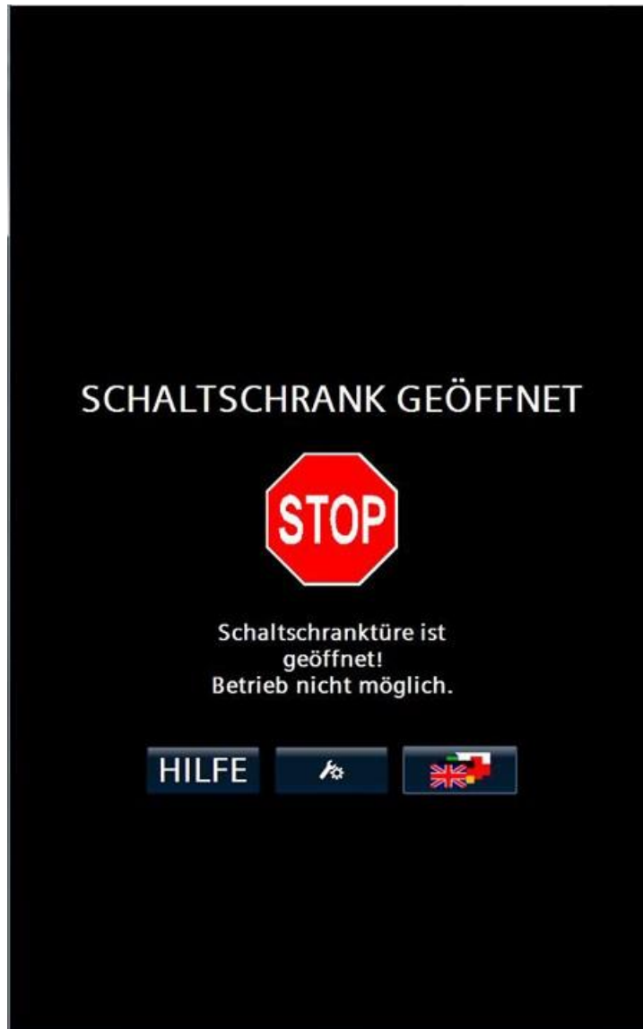
Bild 8-87 Schaltschranktür geöffnet bzw. nicht vollständig geschlossen
