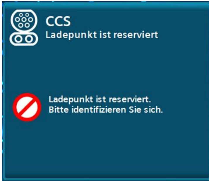
Bild 8-15 Ladepunkt-Reservierung am Beispiel für den DC-Ladeabgang "CCS"
