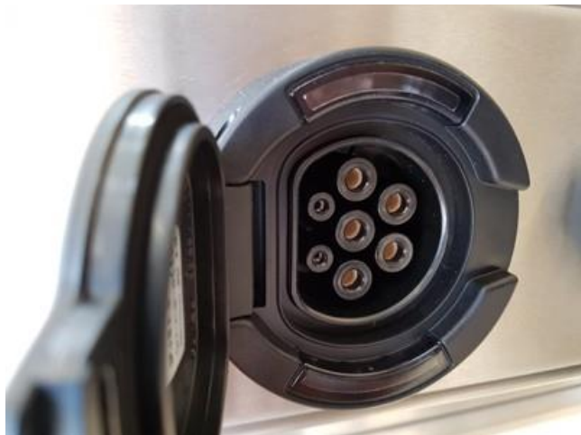
AC-Ladesteckdose von vorn und hinten (Anschlußseite)
